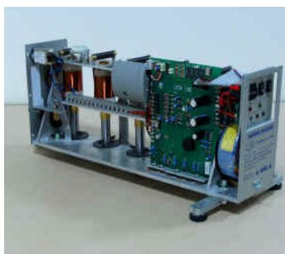
Las partes internas no están fijadas a las cubiertas metálicas, si no a un robusto chasis que permite una construcción robusta y rígida que son esenciales para dar fuerza a la máquina y cumplir con los exigentes requisitos establecidos por la norma ISO 140
